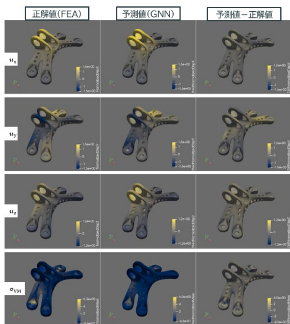
図 7 正解値と予測値の比較例（鉛直载荷） （上から u_x , u_y , u_z , ミーゼス応力）
