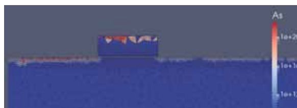
図(c): 4面体のままでの拡散分布As
