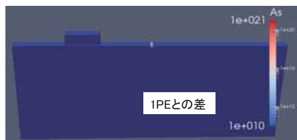
図(a)(240,240): 中央Siの分割境界(濃度差小の場所)に少し差異が見られる
