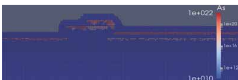
図(c): 構造格子割り付け後(拡散前分布)
