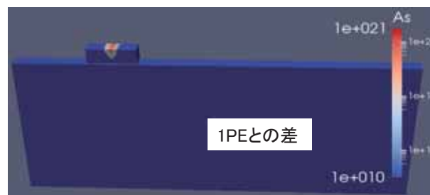
図(b)(120,360): 左側Poly_Siの分割境界(濃度差大の場所)に差異が見られる
