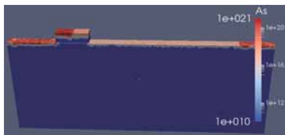
図(b)(120,360): 左側Poly_Siの分割境界(濃度差大の場所)に差異が見られる
