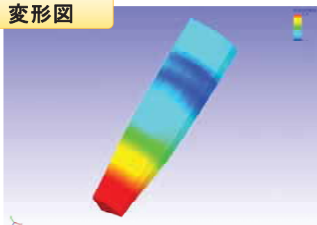
丸棒1/8モデルの変形・ミーゼス応力
