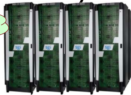
大規模共有メモリサーバ 「SGI UV2000」 理論性能: 49.152TFLOPS core 数: 2,560core 主記憶容量: 32TB ノード内接続: SGI NUMalink6
