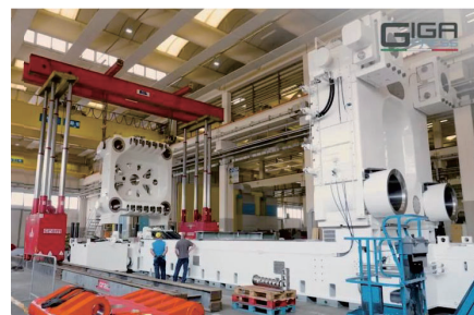
テスラのギガキャスト装置 (アルミニウムのダイキャスト装置)
