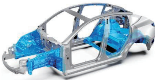
テスラのギガキャスト構造 (アルミニウム)
