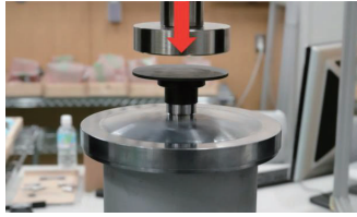
構造不連続部付き球殻座屈試験(鉛アンチモン合金)
