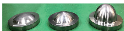
単純球殻座屈試験 形状: JSFR原子炉容器模擬
