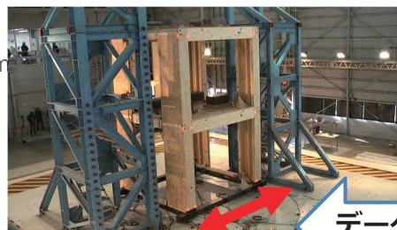
加振 木質ラーメン架構
