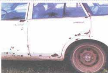
耐食性試験による腐食事例 長距離走行後
