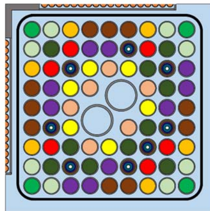
図 2 MVP による BWR 燃料集合体モデル化のイメージ
