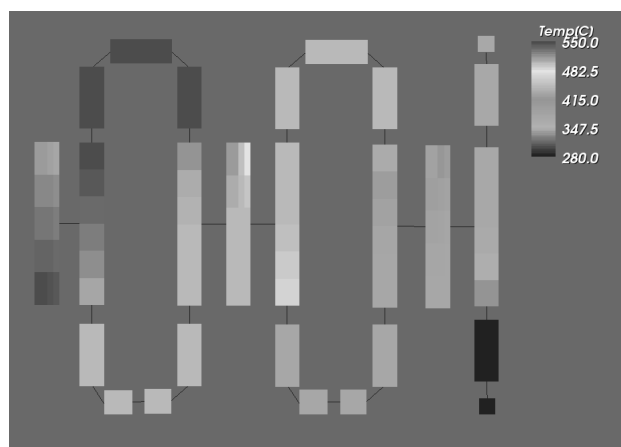
図 13 水流量の異常低下発生から 715s 後の 温度分布 (半陰解法 1、Courant 条件:0.5)
