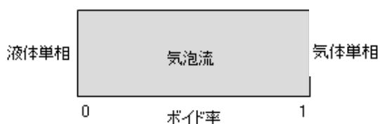
図3 液体単相・気泡流・気体単相に分類する流動様式
