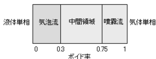
図2 液体単相・気泡流・中間領域・噴霧流・気体単相に分類する流動様式
