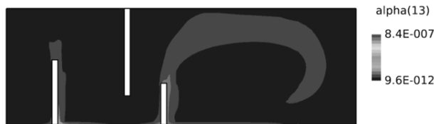
図 35 粒径 80 \mu\text{m} の体積割合
