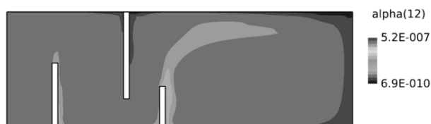
図 34 粒径 63 \mu\text{m} の体積割合
