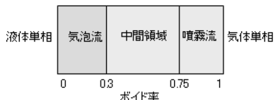
図 1 液体単相・気泡流・中間領域・噴霧流・気体単相に分類する流動様式
