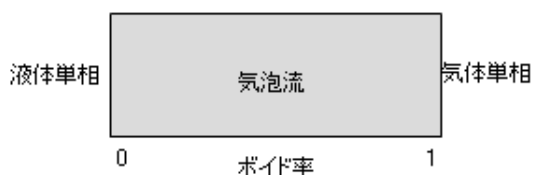
図 3 液体単相・気泡流・気体単相で判定する流動様式
