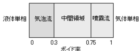
図 2 液体単相・気泡流・中間領域・噴霧流・気体単相で判定する流動様式
