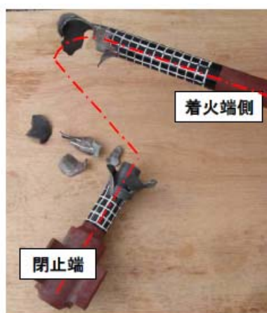
図 13 配管エルボ部の破断(文献[3])
