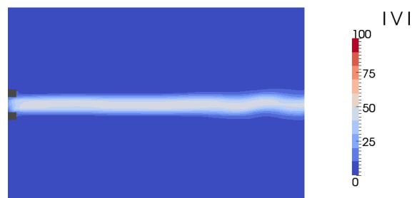
図 30 M=0.1 のケースの流れ場
