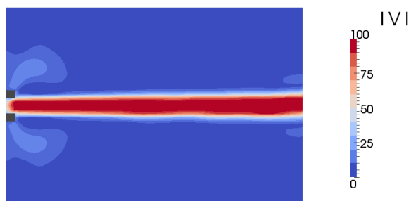
図 32 M=0.4 のケースの流れ場
