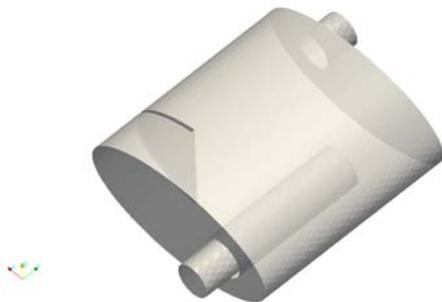
図 83 周波数 780Hz に対して対策したモデル
