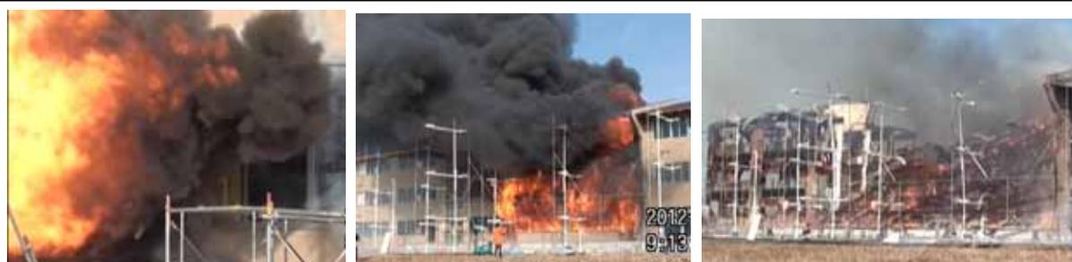
(a) フラッシュオーバー (b) 盛期火災の延焼過程 (c) 構造体崩落過程
