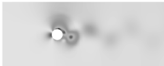
図 6 重合格子による圧力分布の計算結果
