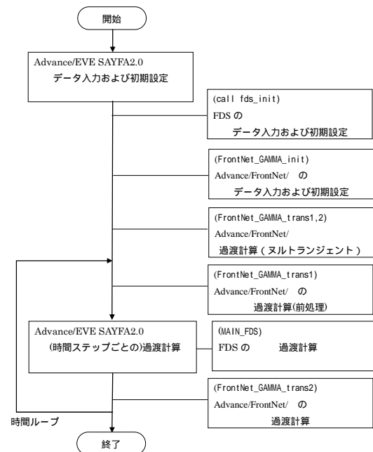
図 3 FDS と連成した場合の処理の流れ
