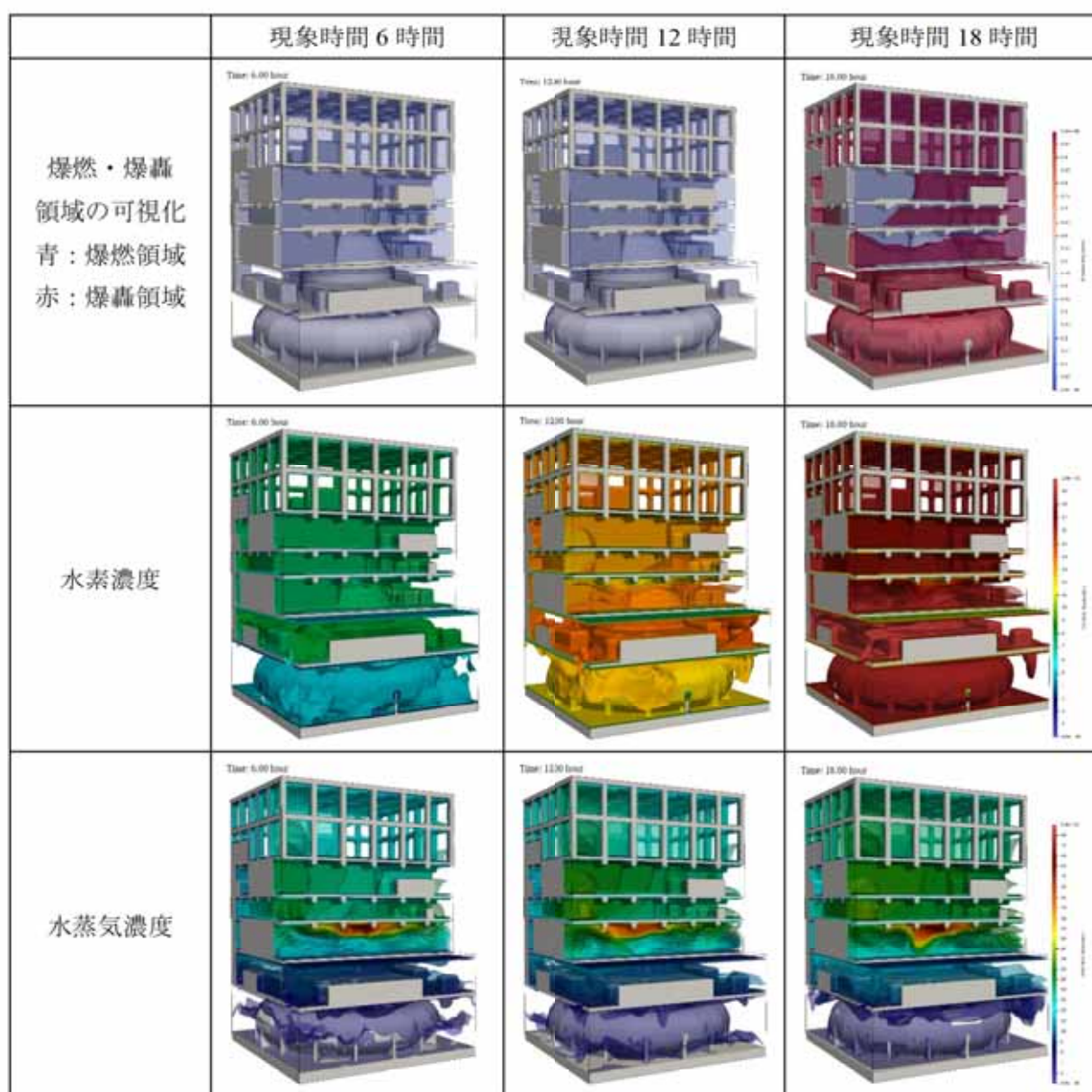
図 2 各時間における各項目の原子炉建屋内の分布図
