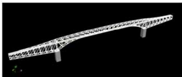
図 1: 計算に使用した解析モデル（橋脚は解析対象外）
