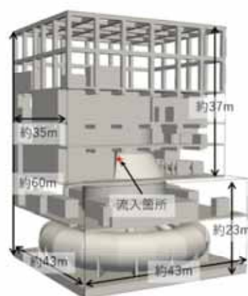
図 1 原子炉建屋モデルと気体の流入箇所
